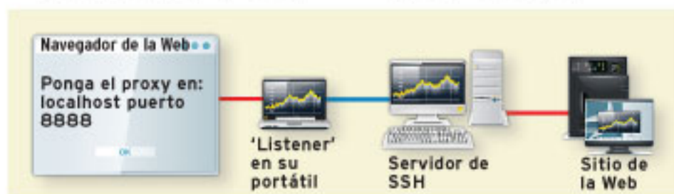
APUNTE SU NAVEGADOR de la Web a "localhost" para enviar tráfico al puerto (llamado escucha o listener) que está configurado para abrir un túnel desde su portátil al servidor de SSH, donde los datos entonces será remitidos al sitio de destino de la Web.
